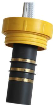
Les 3 bagues métalliques de la crépine doivent être maintenues propres et exemptes de traces d'oxydation pour assurer un bon contact électrique.
